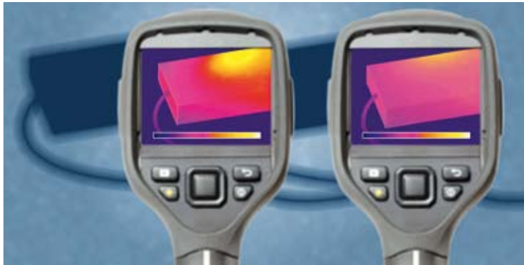
Temperaturvergleich nach Verguss des PUR-Elektrogießharzes
